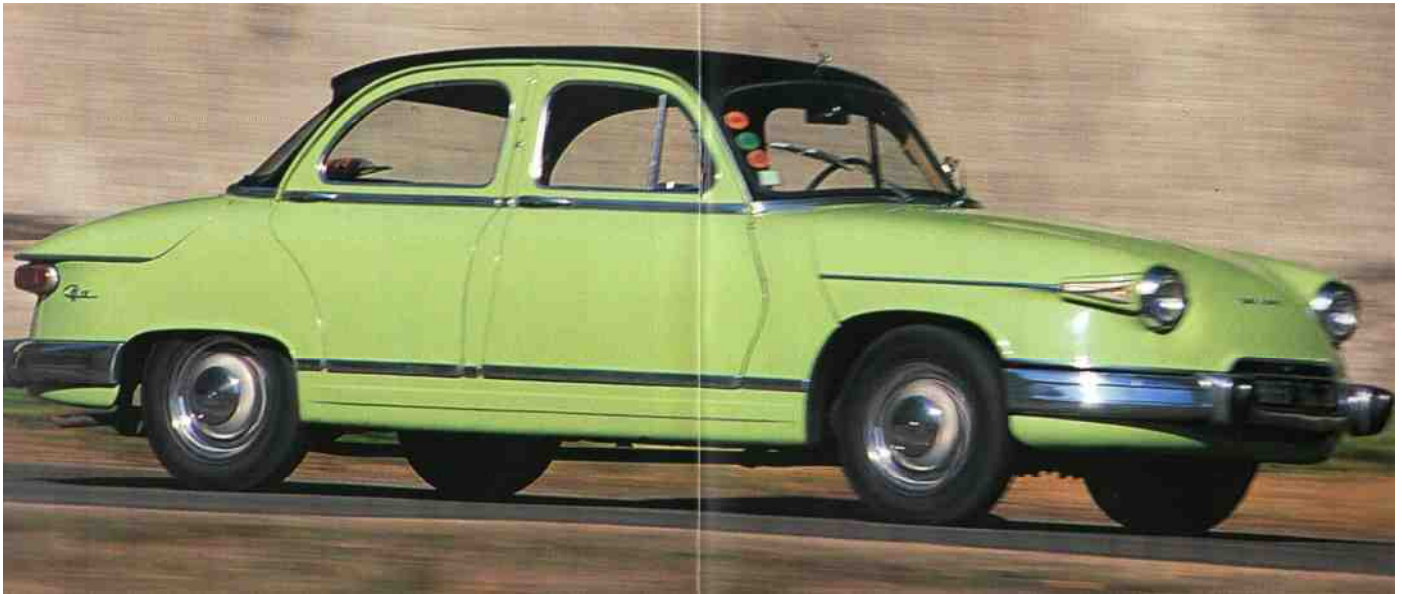
De portieren gaan nu in de goede richting open, van achteren naar voren. Een duidelijke vooruitgang voor deze gezinswagen, die al in 1953 op de markt kwam. Het avant-gardistische imago werd door dit soort details voordien toch wat verstoord
