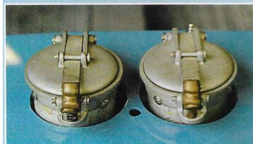
On note deux orifices de remplissage de carburant à ouverture rapide, pour deux réservoirs situés derrière les sièges. Un inverseur est installé pour passer de l'un à l'autre.
